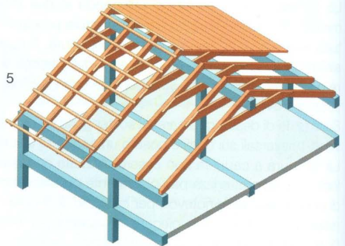
▲ Strutture in legno su muri portanti longitudinali e su travi longitudinali.
